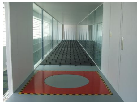
Vista de la cámara de ensayos (plano limitado por la banda de trazos) y la región de generación de cortadura y turbulencia (zona gris oscura) en el Túnel de Viento de Montegancedo (IDR/UPM).
